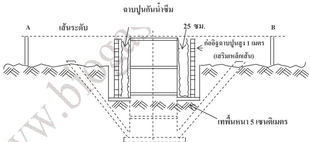
สำหรับผู้ที่ใช้ท่อคอนกรีต เส้นผ่าศูนย์กลาง 1.50 เมตรในการทำบ่อชั้นนอก เมื่อเทพื้นบ่อใหญ่แล้วไม่ต้องรอปูนแห้งให้นำเอาท่อคอนกรีตลงวางได้เลยวางต่อกันให้ครบสองท่อแล้วฉาบรอยต่อเพื่อป้องกันการรั่วซึม
