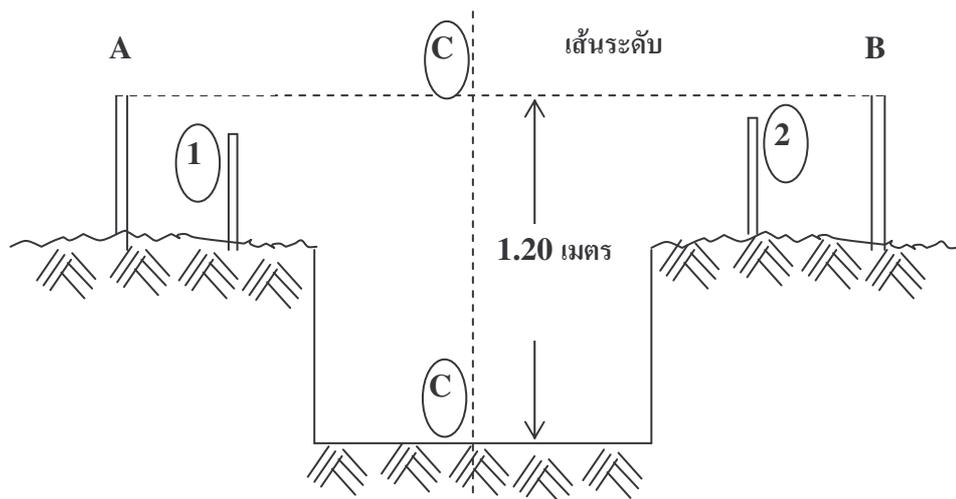
**ขั้นตอนที่ 4** เมื่อได้หลุมใหญ่ ก. แล้ว ให้ทำวงกลมรัศมี 60 เซนติเมตร ที่ก้นหลุมโดยใช้จุดศูนย์กลาง แล้วขุดดินออกตามแนวเส้นรอบวงให้มีความลึกจากเส้นระดับถึงก้นหลุม 2.10 เมตร จะได้หลุมเล็ก ข. จากนั้นขุดแนวท่อทางเข้าและแนวท่อทางออก โดยขุดดินจากหลัก ① ให้เฉียงมาที่ก้นหลุม ข. เป็นแนวท่อทางเข้า และขุดดินจากหลัก ② ให้เฉียงมาที่ก้นหลุม ข. เป็นแนวท่อทางออก
